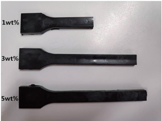
图 8 拉伸断裂标准样条 Figure 8 Tensile fracture standard spline
